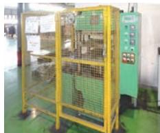
安全柵を設けたプレス加硫設備
