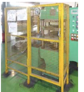
安全柵を設けたプレス加硫設備
