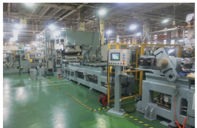
革新製法 (和歌山工場産業用歯付ゴムベルト工程)
