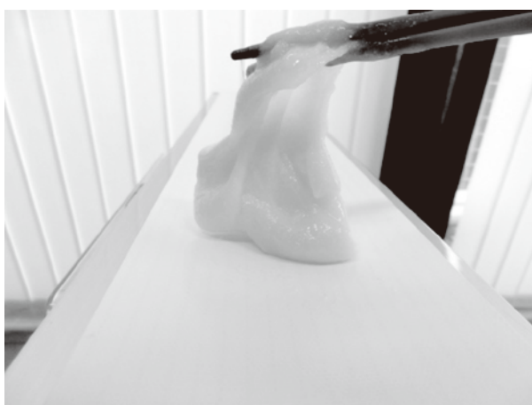
図1. 熱々の餅などの高温で付着性の高い搬送物にも適用します
